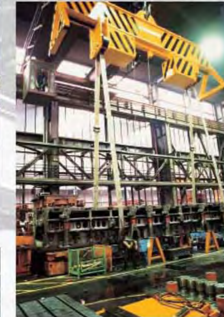
Drehen eines Karosseriewerkzeuges mit ROTOMAX® 45 000 Turning of a press tool with ROTOMAX® 45 000 Retournement d'un outil de presse pour carrosserie avec un ROTOMAX® 45 000
