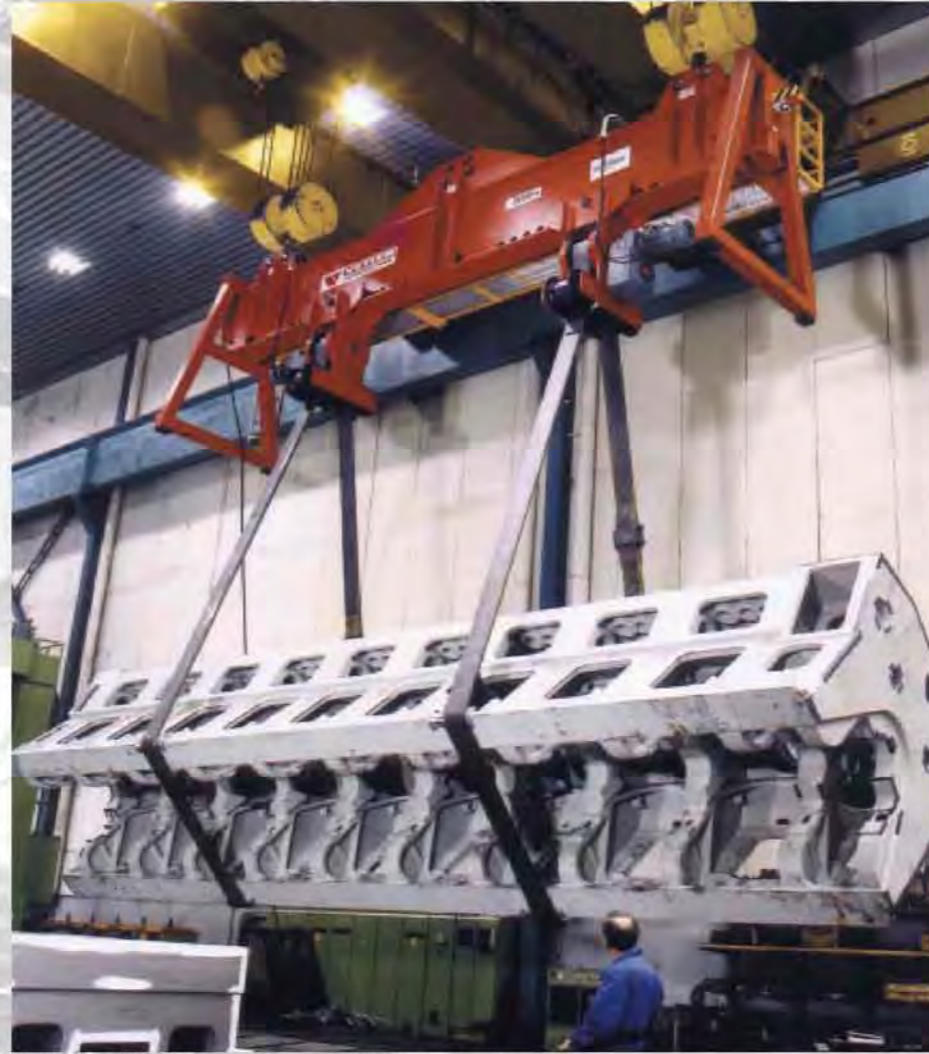
52 t ROTOMAX® beim Drehen eines Schiffsdieselmotors 52 t ROTOMAX® turning a marine diesel engine ROTOMAX® de 52 t tournant un moteur Diesel de marine
