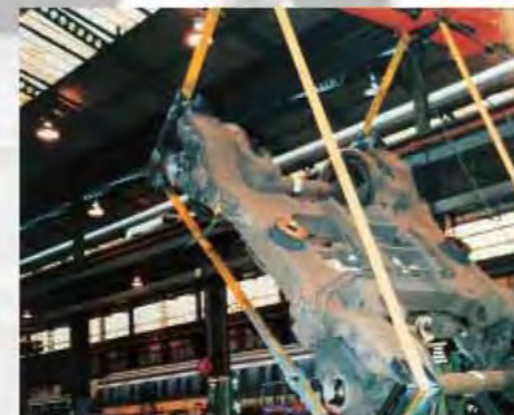
ROTOMAX® VARIO 10 000 bei Reparaturen von Waggonteilen ROTOMAX® VARIO 10 000 rotating a railway bogie for ADTRANZ Ltd. ROTOMAX® VARIO 10 000 pour la réparation d'éléments de wagons
