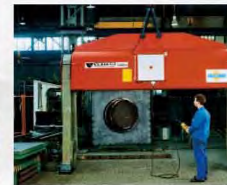
ROTOMAX® mit Infrarotsteuerung in der Betonfertigteileindustrie ROTOMAX® radio controlled to rotate concrete floors ROTOMAX® avec commande infra rouge dans l'industrie du béton
