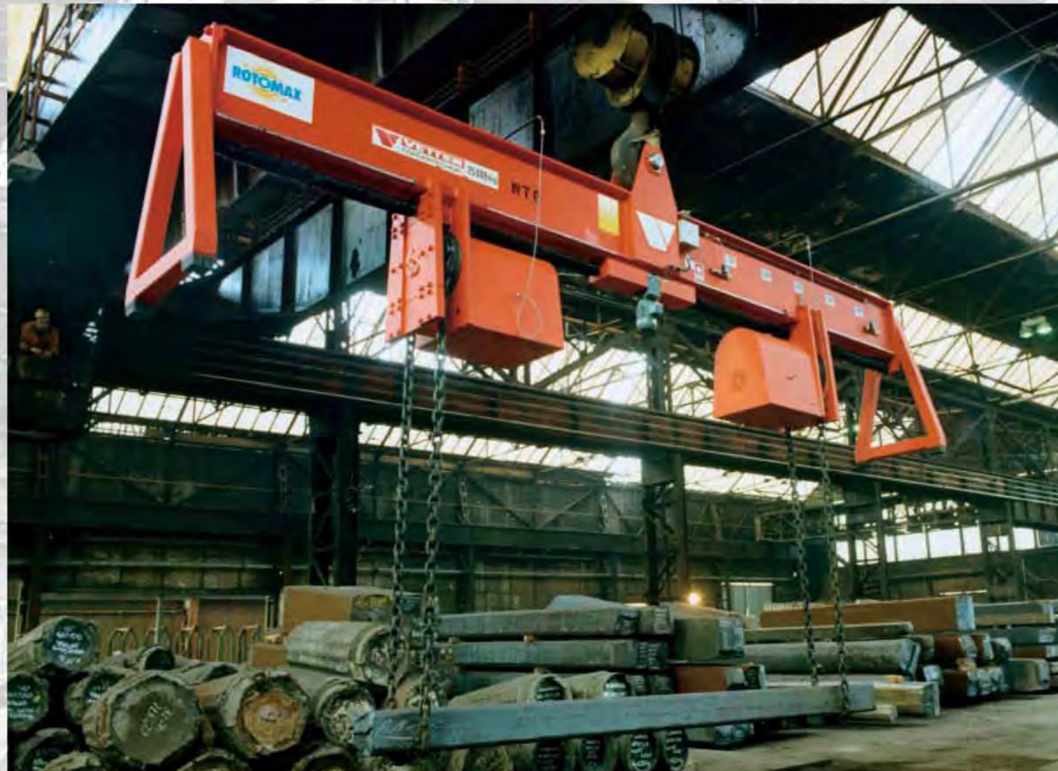
ROTOMAX® 25 000 mit motorischer Seitenverstellung zum Drehen von schweren Schmiedeblocken ROTOMAX® 25 000 with motorized side variation for turning heavy forge blocks ROTOMAX® 25 000 avec réglage motorisé de l'écartement pour retourner des lingots forgés
