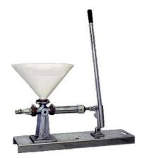
CG-050M 是一種方便攜帶式 , 撬裝 , 手操作灌漿泵 , 重量輕的鋁合金設計 , 使這個灌泵適合小的工作 , 這單元具有 5 加侖料斗和活塞泵 , 該控制料斗直接地連接到 泵的吸力作連續操作 , 此灌漿泵是 2" 正排量手動脈動活塞泵 , 拆卸該系統無需任何工具 , 可作快速和有效地清潔 , 泵為完整的設備並附有免費的 12.5 英尺水泥漿管和一套備用活塞杯。
